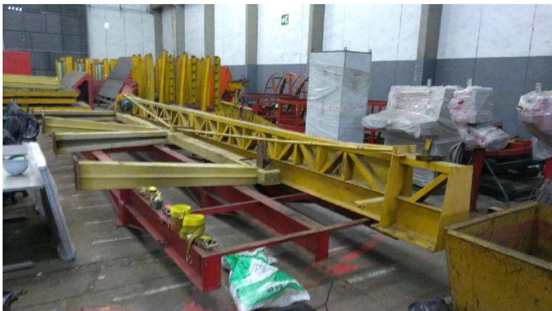
ELEMENTO DE PONTE ROLANTE (PORTICO) (NF 6275) – EQUIPAMENTO DESMONTADO
